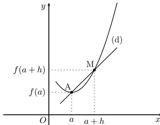
Lorsque  $h$  tend vers 0,  $M$  se rapproche de  $A$  et la droite  $(d)$  se rapproche de la tangente à la courbe  $(C)$  représentant  $f$  au point  $A$ . Le coefficient directeur de  $(d)$  est  $\frac{f(a+h) - f(a)}{h}$ . La tangente en  $A$  à la courbe, si elle existe, a pour coefficient directeur le nombre :  $\lim_{h \rightarrow 0} \frac{f(a+h) - f(a)}{h}$ .
